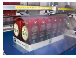
molteplici possibilità di personalizzazione del processo di imballaggio. Rispetto alla versione tradizionale a barra saldante, nella gamma XP a lancio di film la saldatura dei lembi sovrapposti del film rimane nella parte inferiore del pacco e non sui lati dello stesso, migliorando notevolmente l'aspetto estetico delle confezioni realizzate; inoltre rispetto alle versioni a barra saldante è possibile realizzare anche pacchi in film stampato.
